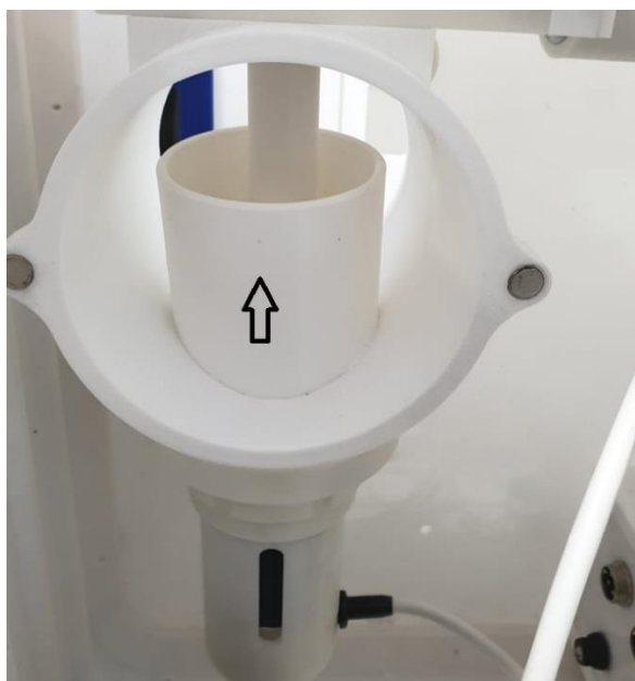
Рисунок 11: Зніміть воронку і очистіть її за допомогою щітки.
