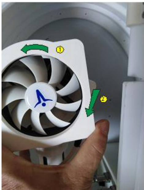
Рисунок 10: Зніміть вентиляторний блок із корпусом (утримується магнітами) та ретельно очистіть щіткою.
